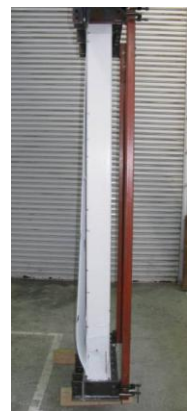
破壊状況 (鋼板の剥離)
