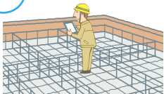
基礎配筋工事の完了時
