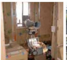
気密測定器による気密のテスト。第三者による、公正なチェックが行われている記録が残ります。
