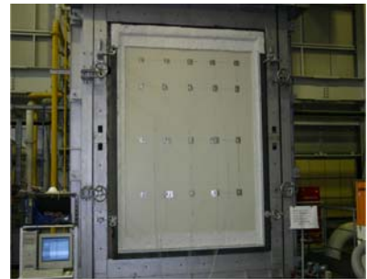
鋼板張パネル耐火性能評価試験
